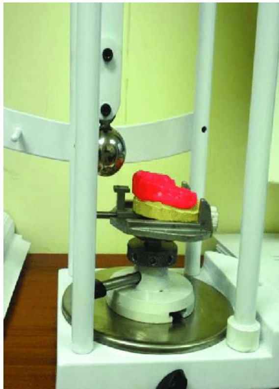
Figura 2.7 - Estrutura do teste de pêndulo (Mohamed et al. , 2017).
