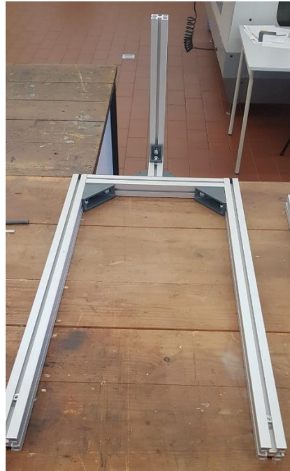
Figura 3.7 - Estrutura de fixação da posição de lançamento do pêndulo.
