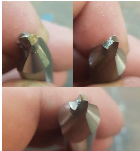
Figura 4.3 - As 3 brocas utilizadas e o dano causado nas mesmas pela esfera.
