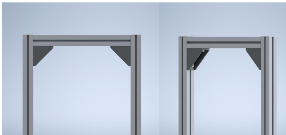
Figura 3.6 - Visualização do ângulo de fixação da barra horizontal superior aos pilares no programa Inventor® 2021.
