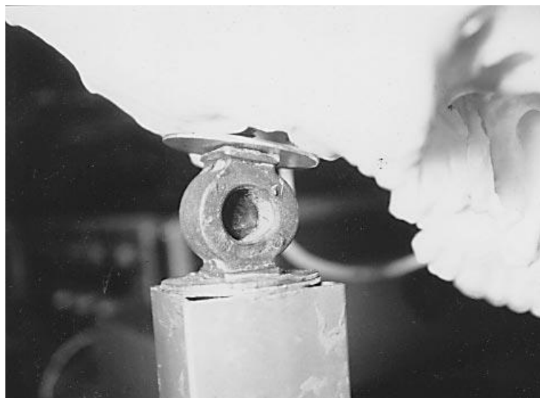
Figura 2.13 - Sistema de mola com configuração O-mount (de Wet et al. , 1999).
