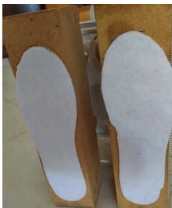
Figura 3.6. Palmilhas de cortiça coladas à base dos sistemas SM1 e SM2, produzindo uma área de contacto semelhante às palmilhas Pedar® V 1872 R / 1869 L.
