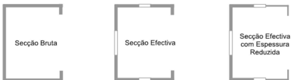
Figura 2.16 – Secção em C: a) Bruta; b) Efetiva; c) Efetiva com espessura reduzida (Silvestre, 2009)
