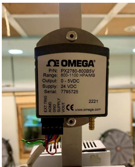
Figura 26 - PX2780-800B5V da Omega instalado na CC.
