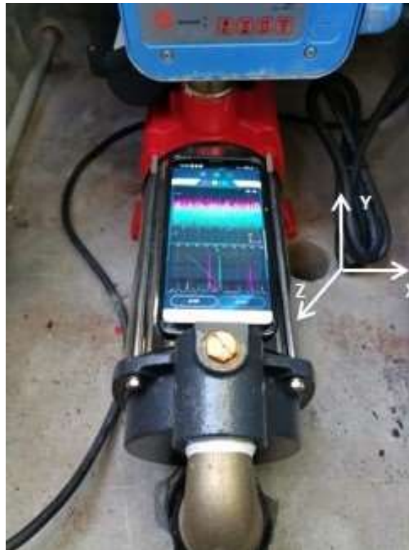
Figura 3.3: Orientação dos 3 eixos do acelerómetro colocado sobre o motor da bomba.
