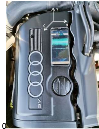
Figura 3.1: Orientação dos 3 eixos do acelerómetro colocado sobre o motor de automóvel.
