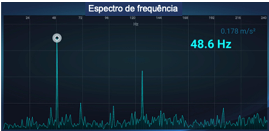
Figura 3.4: Espectro das frequências da vibração da bomba de água, segundo o eixo Z. Verificamos que a frequência com maior aceleração é a de 48,6 Hz, com uma aceleração de 0,178 m/s 2 .
