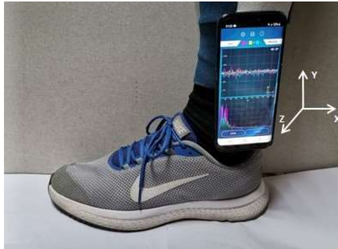
Figura 3.7: Orientação dos 3 eixos do acelerómetro colocado sobre a parte lateral da perna.
