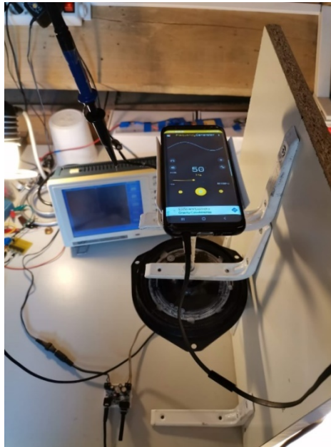
Figura 5.17: Vista superior da montagem em plataforma vertical, para análise da resposta do transdutor VEG-50.
