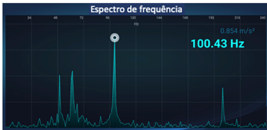
Figura 3.6: Espectro das frequências da vibração da furadeira segundo o eixo Z.
