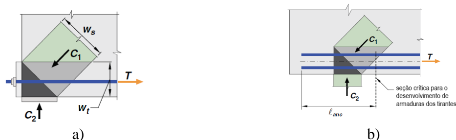
Figura 2.25 – Representação da ancoragem das armaduras dos tirantes. a) forças de tração ancoradas por placas. b) forças de tração ancoradas por armaduras embutidas. Fonte: (American Concrete Institute, 2019h)
