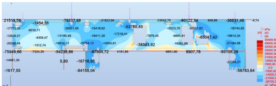
Figura 4.22 – Valor das tensões principais de compressão para o carregamento associado, no ELU (kPa).
