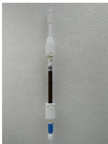
**Figura 3.10.** Reator de coluna compactado com Amberlite IR-120 (**CAT5**).
