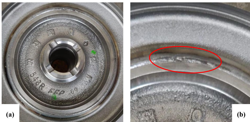
Figura 6.8. Amostra do ensaio 3 soldada a 360°: (a) Cordão de soldadura; (b) Zona do recobrimento.
