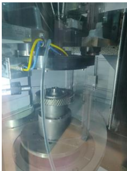
Figura 5.1. Caixa diferencial colocada em posição de soldadura.
