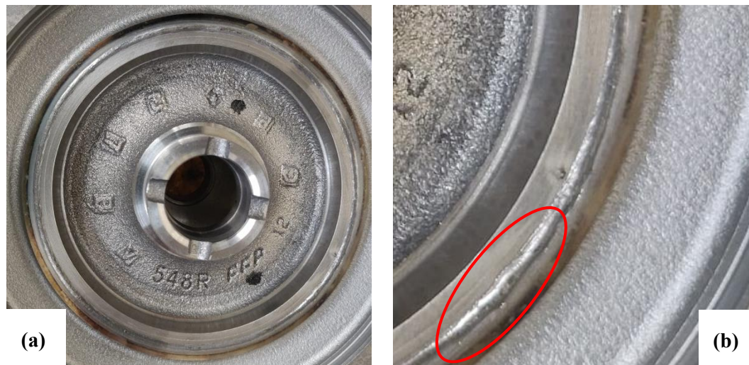
Figura 6.9. Amostra do ensaio 5 soldada a 360°: (a) Cordão de soldadura; (b) Zona do recobrimento.
