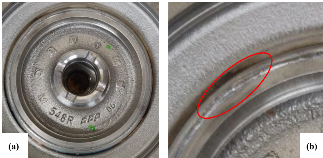
Figura 6.7. Amostra do ensaio 1 soldada a 360°: (a) Cordão de soldadura; (b) Zona do recobrimento.
