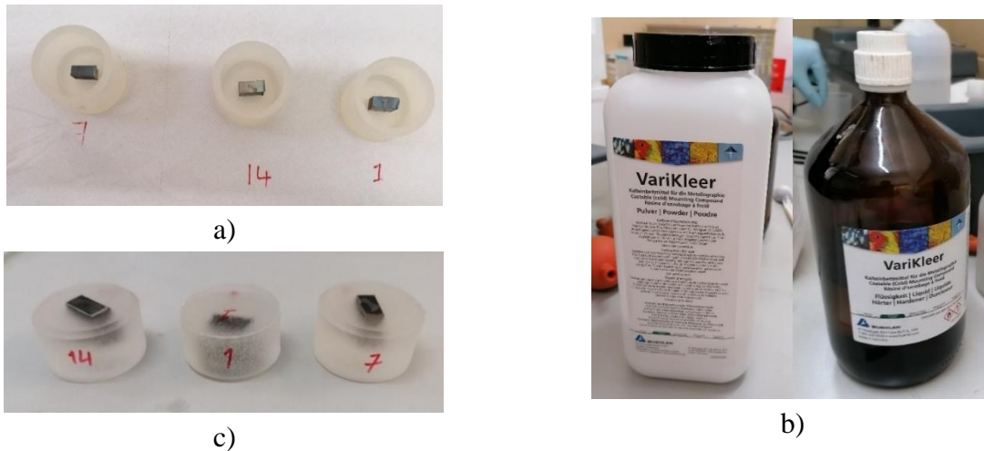
Figura 3. 19 – a) Amostras no molde; b) Resinas utilizadas (Castable (Cold) Mounting Compound Liquid|Hardner + Castable (Cold) Mounting Compound Powder); c) Amostras embutidas na resina. (Fonte: Autor)
