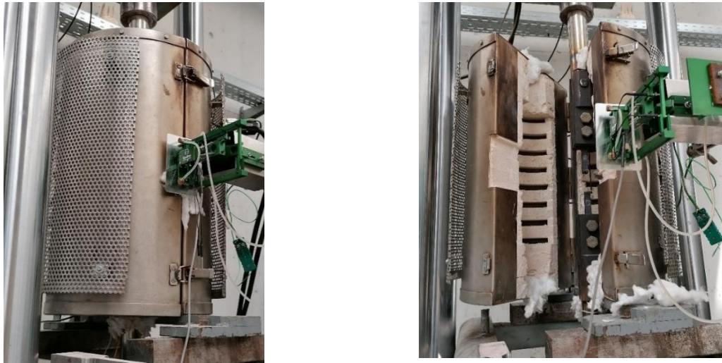
Figura 3. 3 – Forno elétrico: a) Fechado; b) Aberto. (Fonte: Autor)
