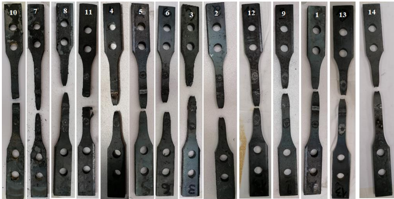
Figura 3.7 - Ilustração dos provetes, correspondente a cada temperatura, após término dos ensaios (Modos de rutura dos ensaios em regime transiente - S355). (Fonte: Autor)
