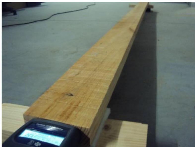
Figura 2 - Utilização do Timber Grader MTG na caracterização mecânica não destrutiva (Martins, 2019).
