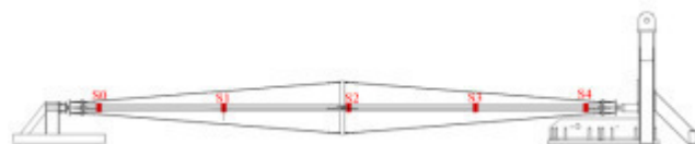
Figura 3.4 – Posicionamento dos extensómetros ao longo da coluna (retirado de D4.1.1 – HILONG )
