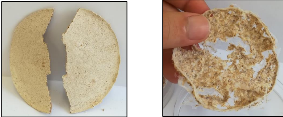
Figura 3.18. Fotografia de compostos PLA dissolvidos em DCM:MeOH (7:3) (esquerda) e DCM:MeOH (7:3) CF (direita).
