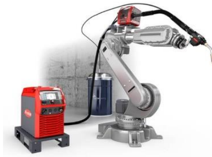
Figura 3.5 – Robô manipulando tocha de soldadura – Fronius [45].
