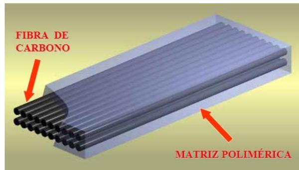
Figura 2.6 – Composição de um compósito CFRP (Bezerra e Santos, 2019).
