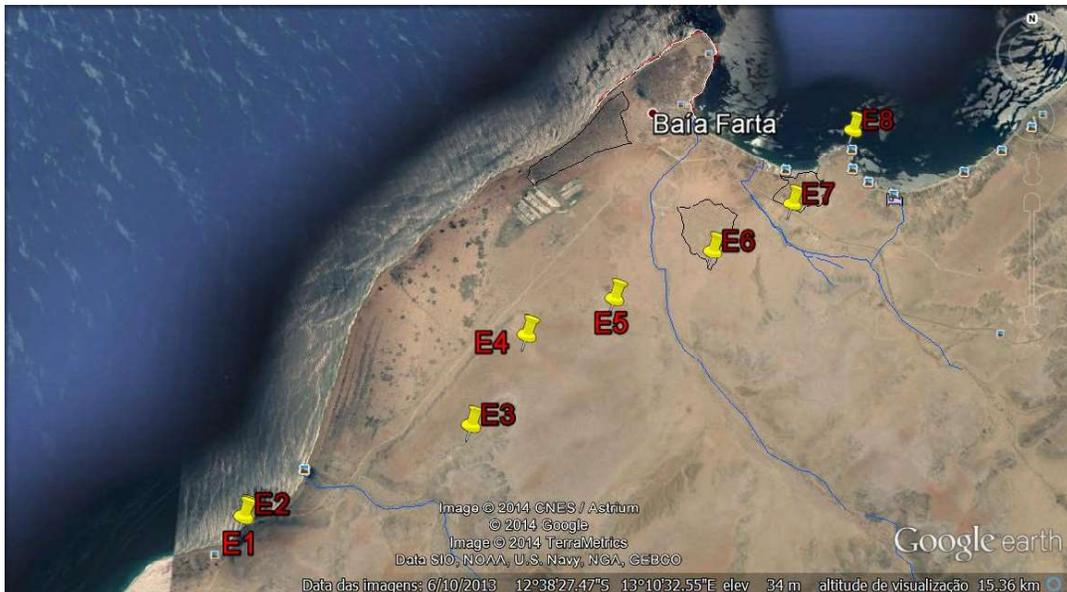
Fig.5.2. Estações com afloramentos seleccionados para ensaios com ácidos que revelaram a presença de materiais calcários.
