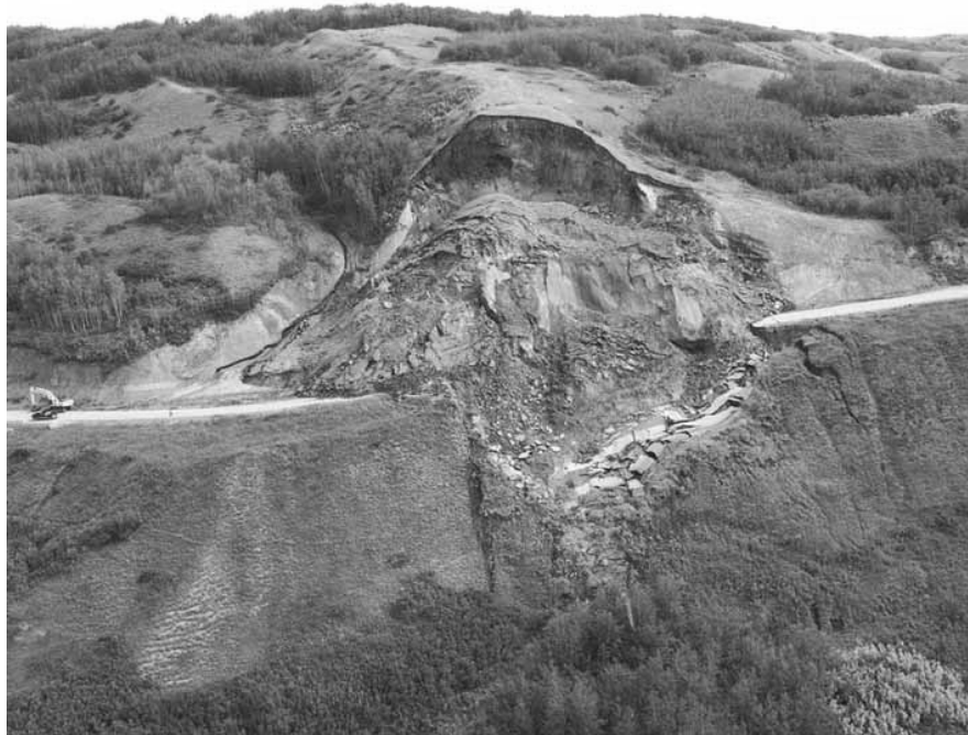
Figura 4.12 – Deslizamento translacional que ocorreu em 2001 no Vale do Rio Beaton, British Columbia, Canada. (Réjean Couture, referido em Highland e Bobrowsky, 2008).
