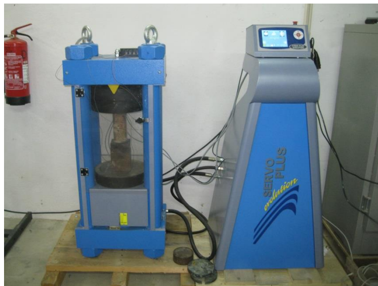
Figura 5.2 – Prensa rígida servo-controlada utilizada para os ensaios de resistência compressão uniaxial.
