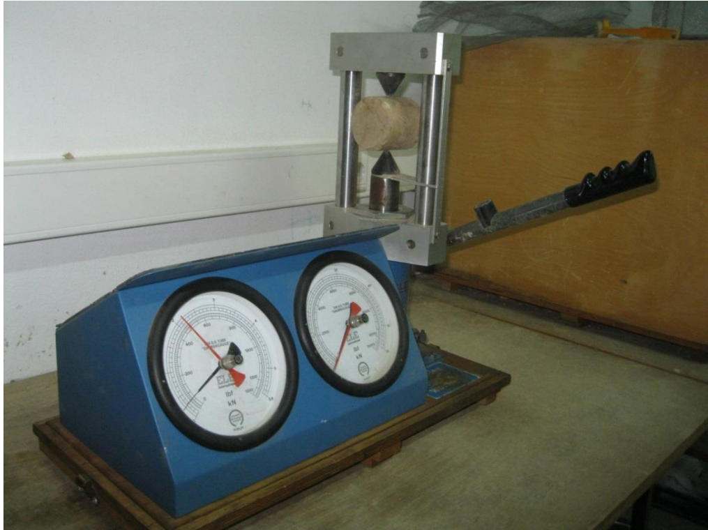
Figura 3.6 - Equipamento de Point Load Test que permite a determinação da resistência à carga pontual dos materiais rochosos.
