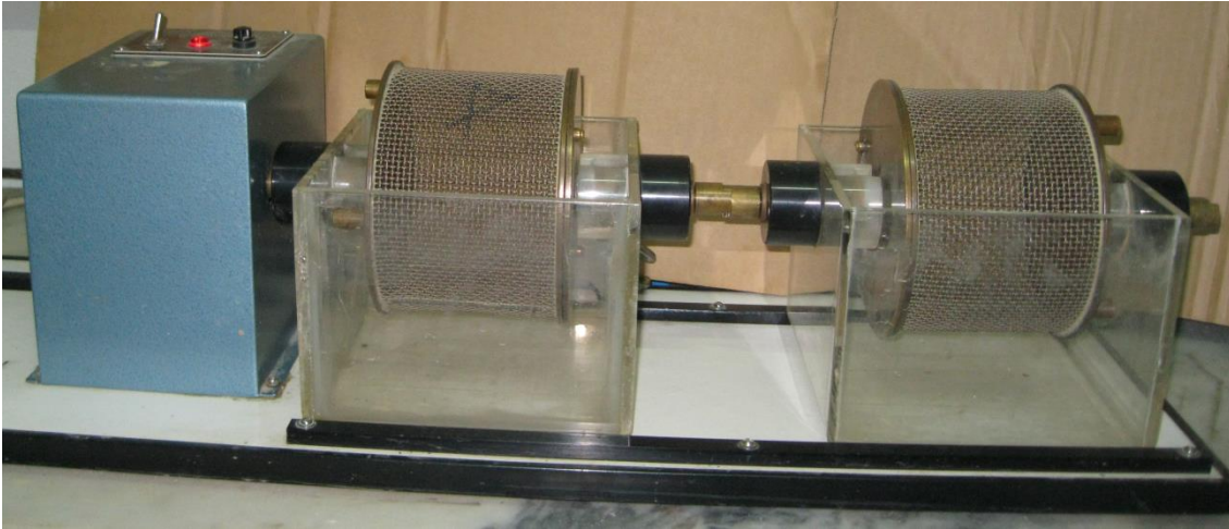
Figura 3.10 – Equipamento utilizado no ensaio de desgaste em meio húmido.
