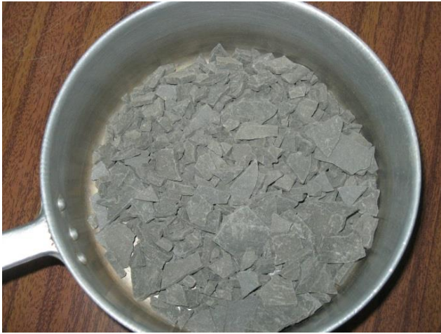
Figura 5.3 – Mistura de enxofre com argilas no estado sólido.
