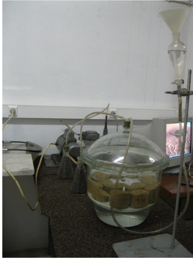
Figura 3.3 – Ensaio de massa volúmica aparente e porosidade aberta.
