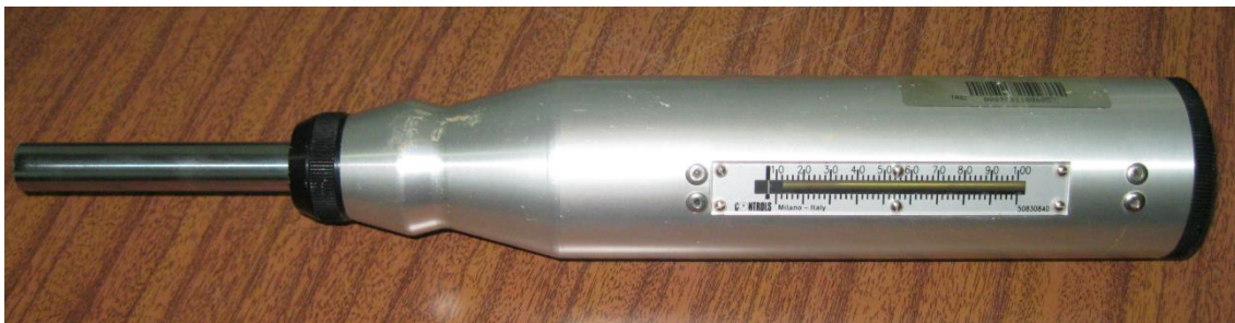
Figura 3.4 – Esclerómetro do tipo de Schmidt utilizado para determinação da dureza de Schmidt (R) nos ensaios em laboratório.
