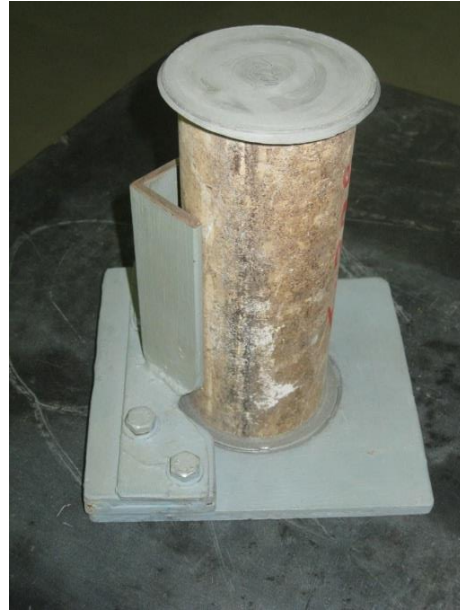
Figura 5.4 – Molde usado para retificação dos provetes, com um dos topos já capeado.
