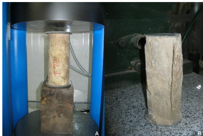
Figura 5.5 - A) Provete antes do ensaio; B) Provete após o ensaio.
