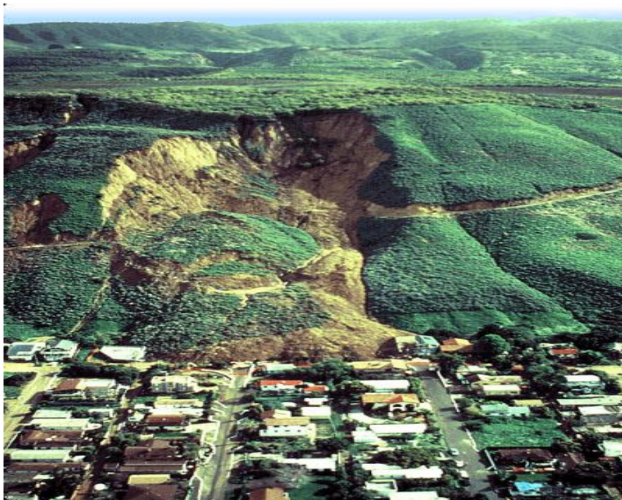
Figura 3.5 - Movimento de deslizamento rotacional (retirado de USGS (2004)).
