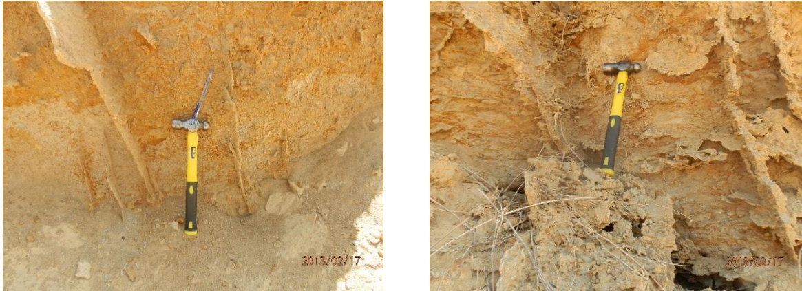
Figura 2.14- Fotografias ilustrando gesso e raízes do local de estudo (Talude 9).
