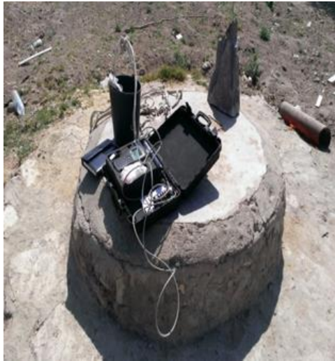
Figura 17. Aparelho multiparâmetros no poço CH9. Figura 18. Medição direta no poço CH9.
