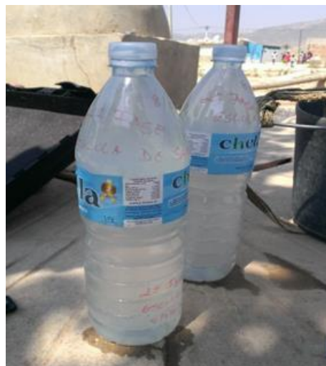
Figura 19. Tipo de garrafa para amostragem e codificação a vermelho.
