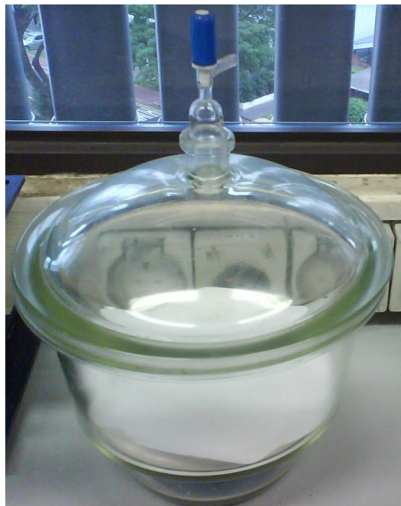
Figura 3.1 – Recipiente para a realização do ensaio de determinação da massa volúmica e da porosidade aberta
