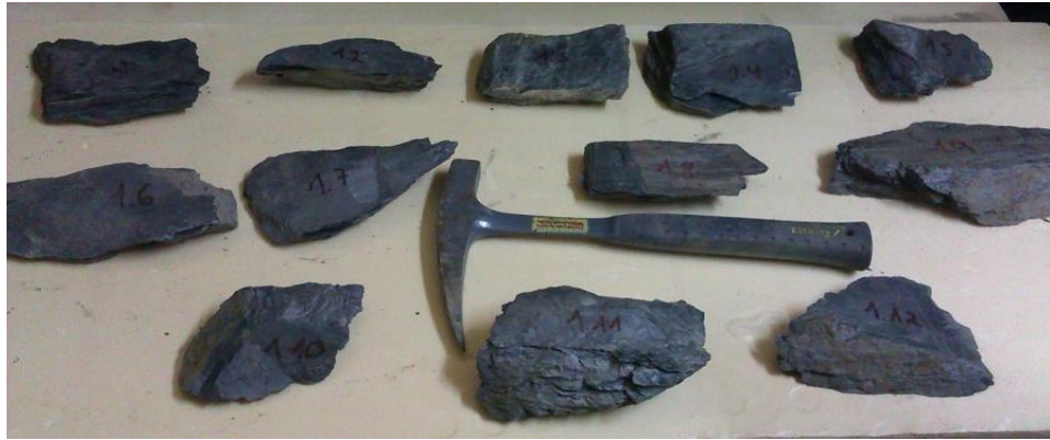
Figura 3.4 - Provetes utilizados no ensaio de carga pontual
