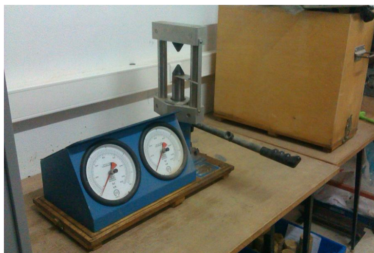
Figura 3.2 – Equipamento portátil utilizado no ensaio de resistência à carga pontual
