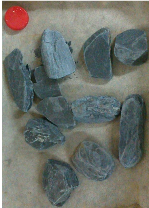
Figura 3.10 – Provetes usados na realização do ensaio de desgaste
