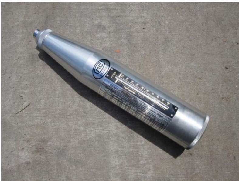
Figura 2.1 - Equipamento de esclerómetro do tipo Martelo de Schmidt
