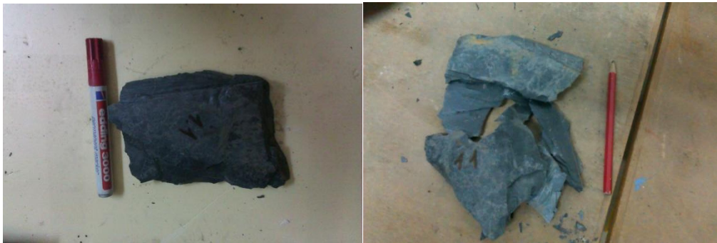
Figura 3.6 – Proвете antes e depois da realização do ensaio de carga pontual
