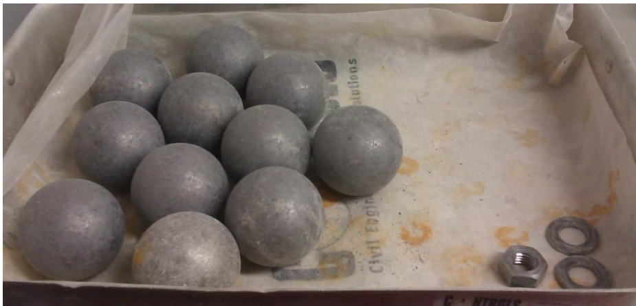
Figura 3.8 – Carga abrasiva utilizada no ensaio de Los Angeles
