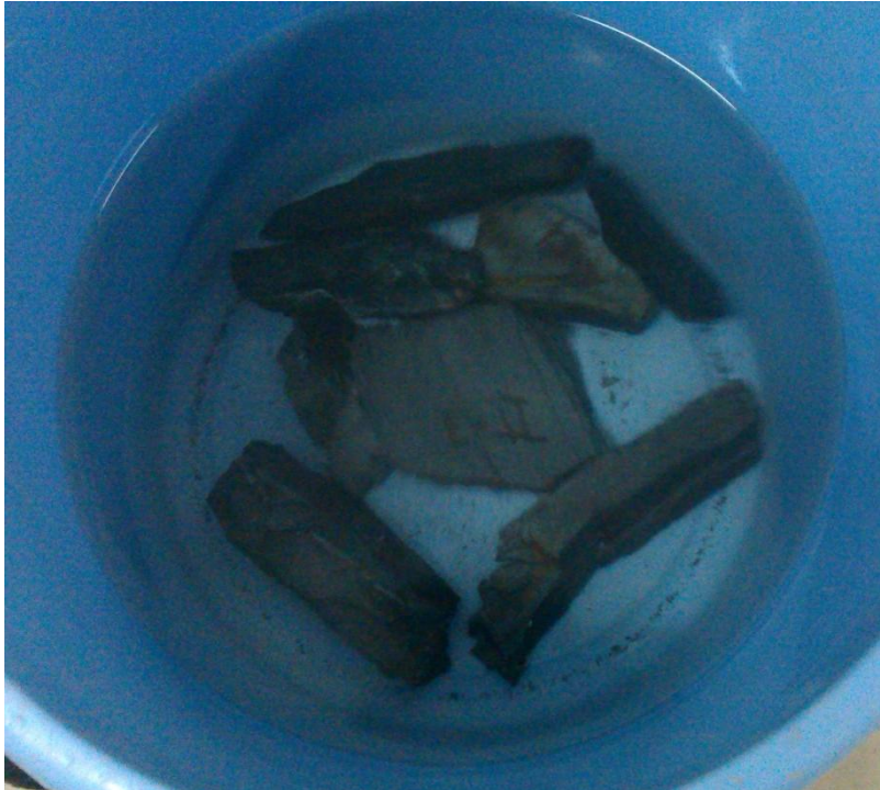
Figura 3.9 – Provetes utilizados na realização do ensaio de absorção de água
