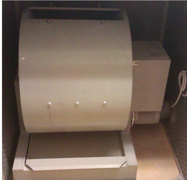
Figura 3.7 – Tambor metálico usado na realização do ensaio de Los Angeles
