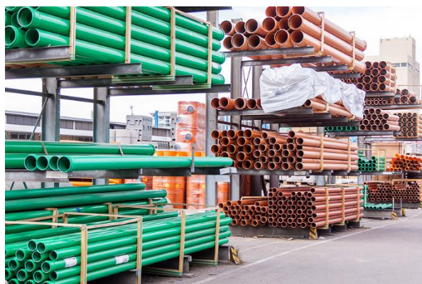
Figura 2.9. Sistema de estantes cantilever . Fonte: [8].
