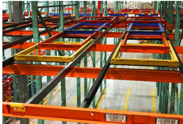
Figura 2.7. Sistema de paletização push-back . Fonte: [19].
