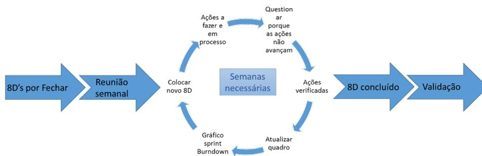
**Figura 4.13.** Esquema do processo de implementação de melhoria no seguimento das ações dos 8D's
