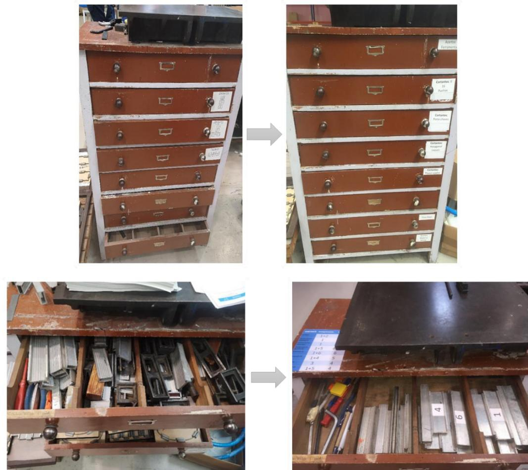
Figura 10- Aplicação da Seleção, Arrumação e Limpeza ao armário dos cortantes
