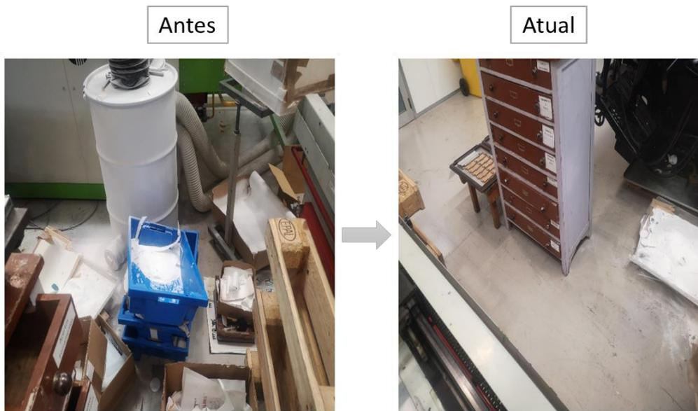
**Figura 7-** Aplicação da Seleção, Arrumação e Limpeza ao chão da secção
