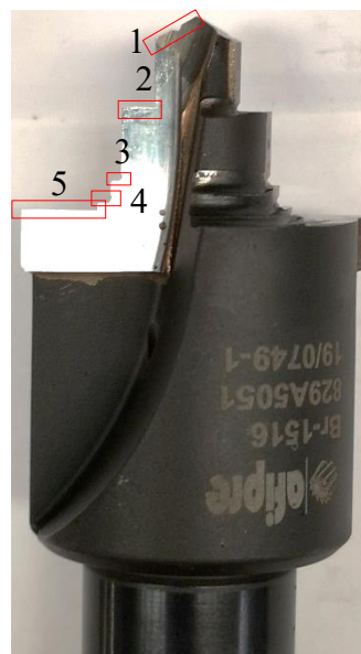
Figura 49 – Aresta de corte da broca de acabamento 5.
