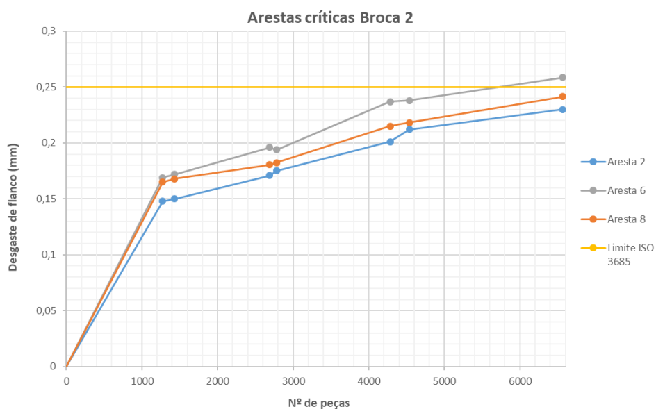
Figura 45 – Desgaste de flanco nas arestas críticas da broca de acabamento 5 (cruzamento de dados dos dois conjuntos-teste).
