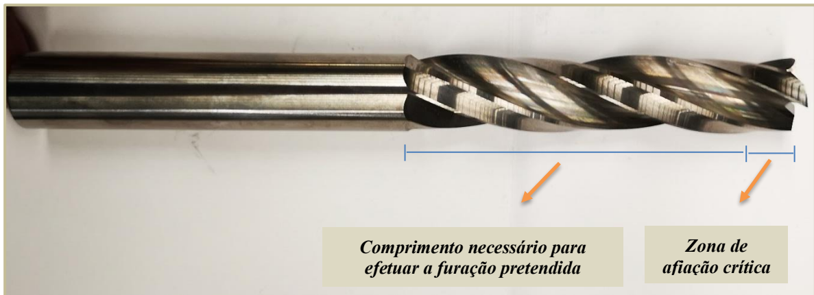
Figura 58 – Zona de afiação principal – Desbaste.
