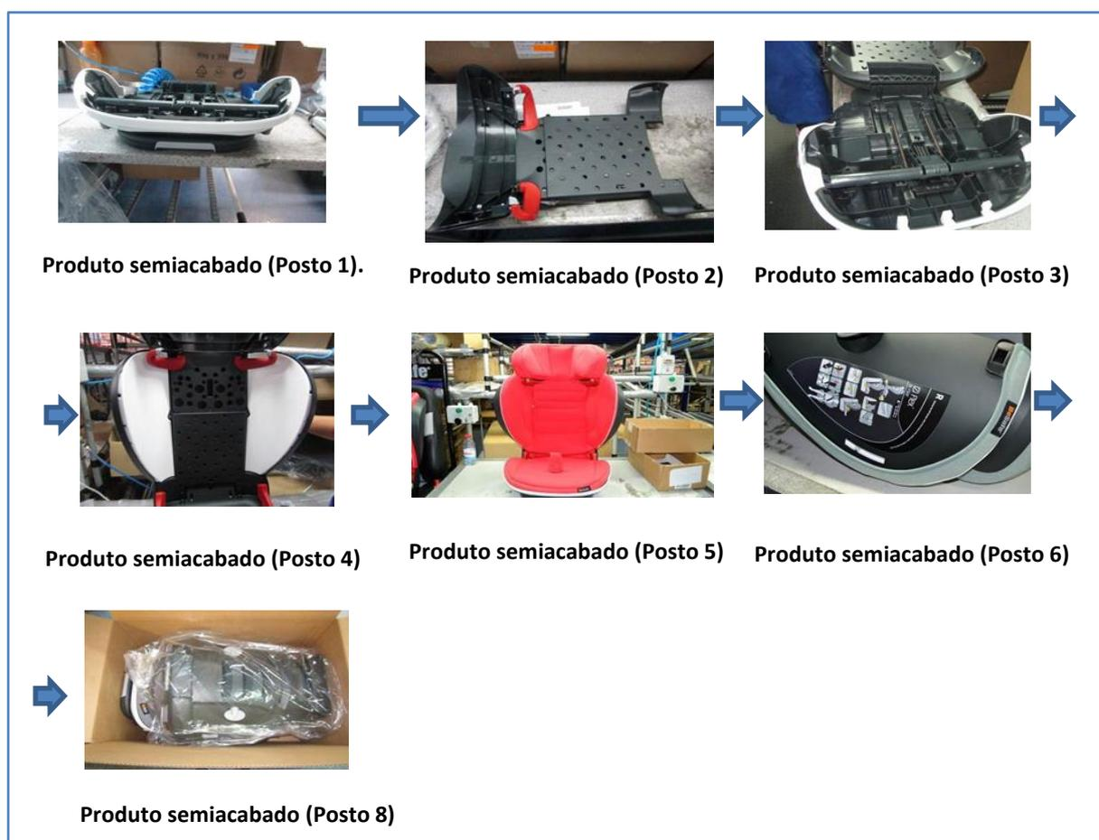
Figura 16 - Sequência do produto na linha de montagem
