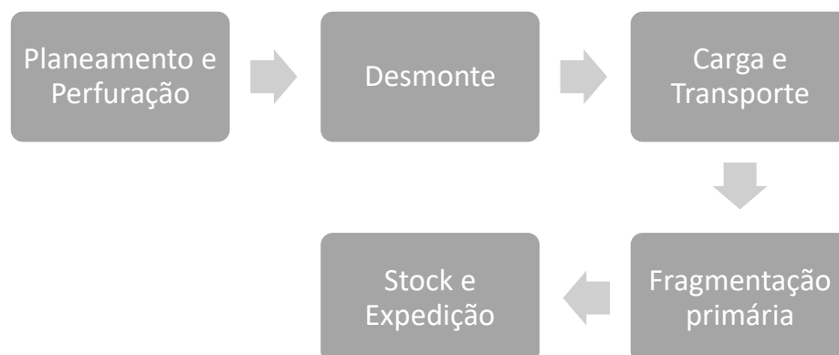
Figura 5 - Ciclo das operações mineiras na exploração de uma pedreira de agregados
