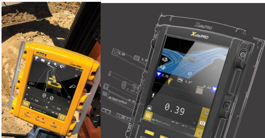
Figura 48 - Sistema de controlo do processo de perfuração, XSite Pro 3D Drilling (moba-automation.com.br)(Setembro 2021)
