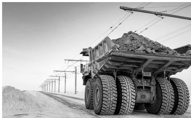
Figura 11 - Dumper com Sistema Trolley Power Assist (:new.abb.com)(setembro 2021)
