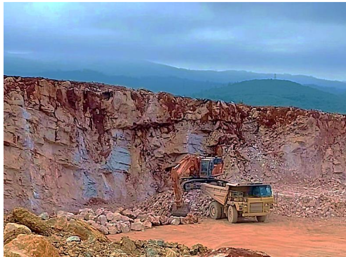
Figura 28 - Carregamento de Dumper
