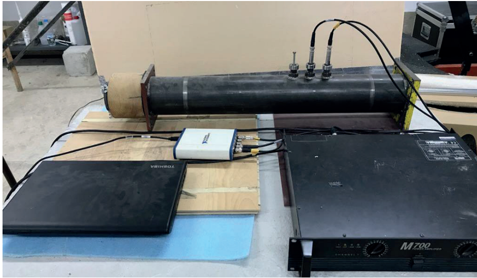
Figura 4.1 – Equipamento utilizado no método do tubo de impedância, para determinação da absorção sonora de materiais.
