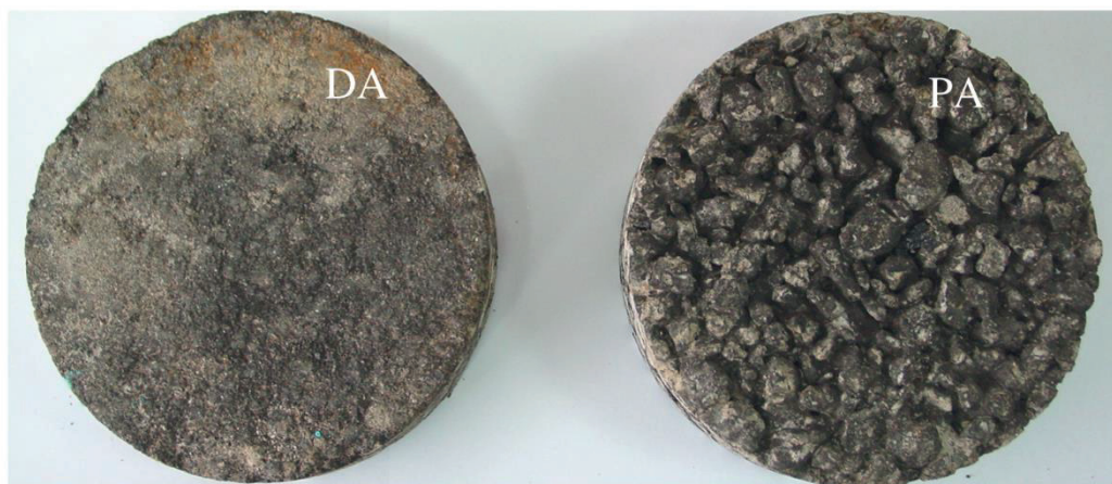
Figura 2.5 - Aspeto do asfalto: DA - Asfalto denso e PA - Asfalto drenado (Freitas, E., Pereira, P., de Picado-Santos, L., & Santos, A., 2009).
