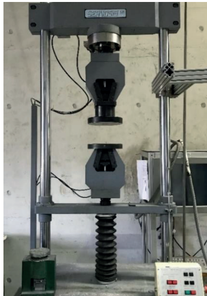
Figura 3.13 - Prensa hidráulica de 10T utilizada nos ensaios mecânicos de compressão e flexão.
