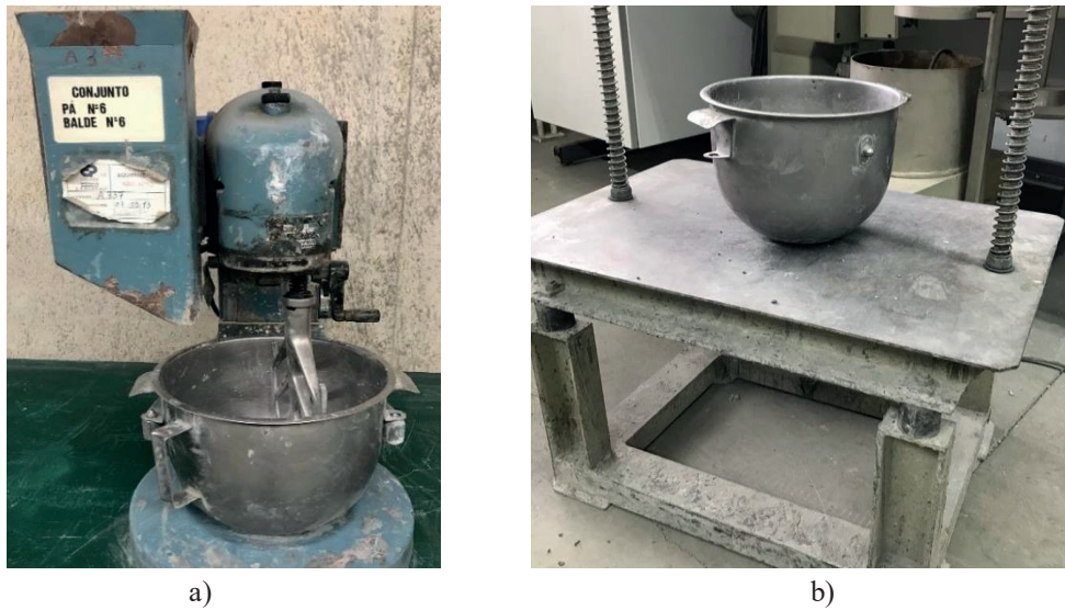
Figura 3.6 – Misturadora mecânica (a) e a placa vibratória (b) utilizadas na produção das amostras de betão.
