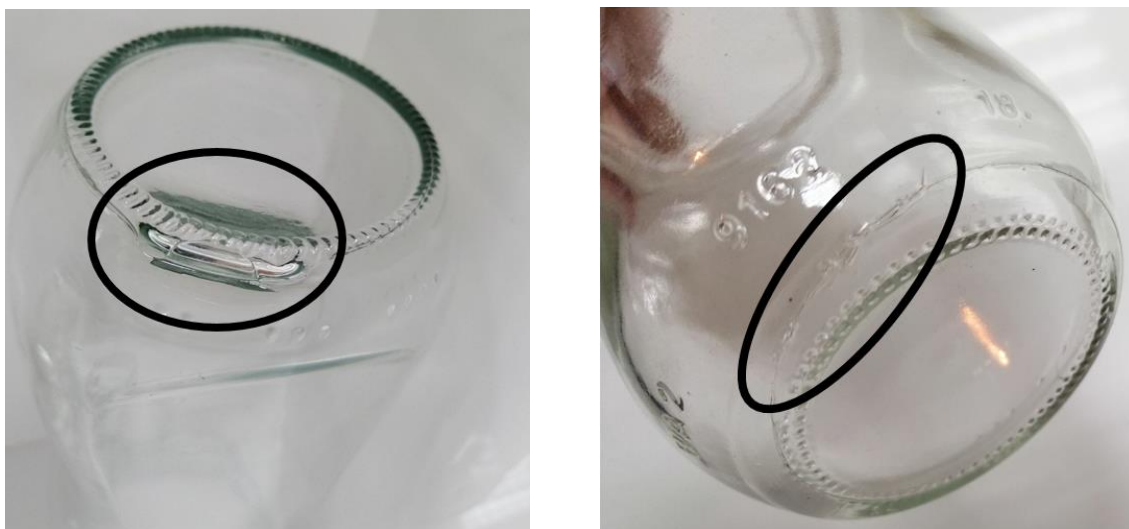
Figura 5 - Ilustração dos defeitos vidro mastigado no fundo e costura do fundo mastigada.
