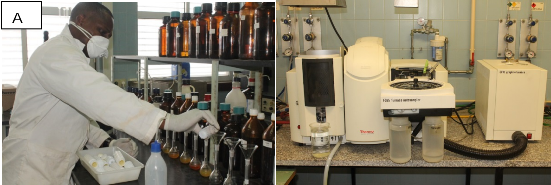
Fig. 3.5 (A) Tratamento das amostras para análise química. (B) Um dos equipamentos usados para a análise química, o Espectrofotômetro de Absorção Atômica FS95 Furnace Autosampler.
