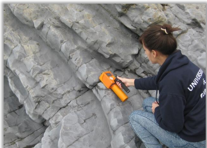
Figura 4.1 – Medição realizada com o espectrómetro portátil Gamma surveyor II , orientado perpendicularmente em relação à superfície de estratificação da camada.
