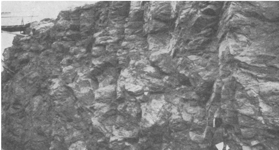
Figura 5.14 - Disjunção prismática no pórfiro (Sousa do Vale, 1960).
