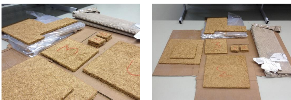
Figura 3.5 – Placas do compósito de casca de arroz e aglomerado de cortiça.
