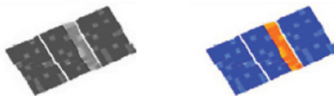
Figura 4.7– Anomalia ao longo de uma linha do módulo (DBD).
