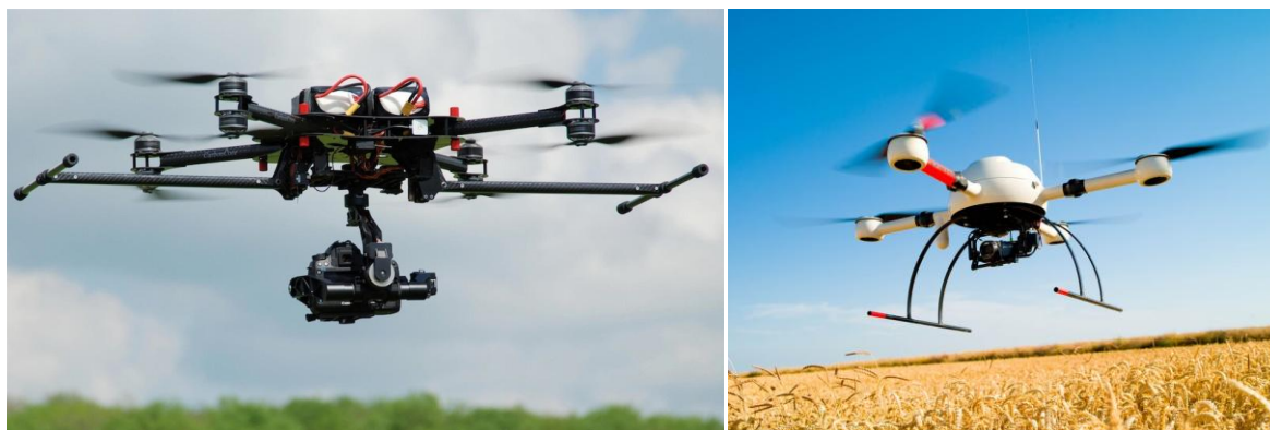
Figura 2.8 – RPAS com MTOW inferior a 25 kg e inferior a 5kg, respectivamente (Panoramaaudiovisual e Microdrones, 2015).
