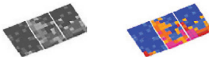
Figura 4.9– Anomalia em várias células individuais na parte inferior do módulo (PID).
