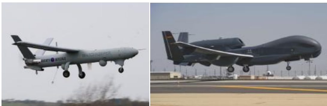
Figura 2.6 – RPAS com MTOW superior a 150 kg (Catini, 2014).
