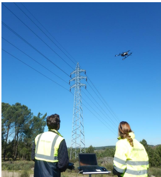
Figura 2.16- Inspeção de linhas elétricas (Marques e Ferreira, 2015).
