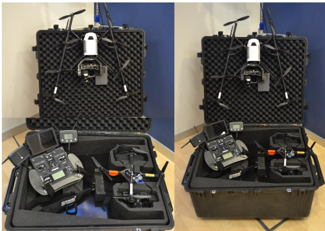
Figura 4.2– Falcon 8 e equipamento adicional utilizado nos planos de inspeção pela empresa Aeroprotechnik.
