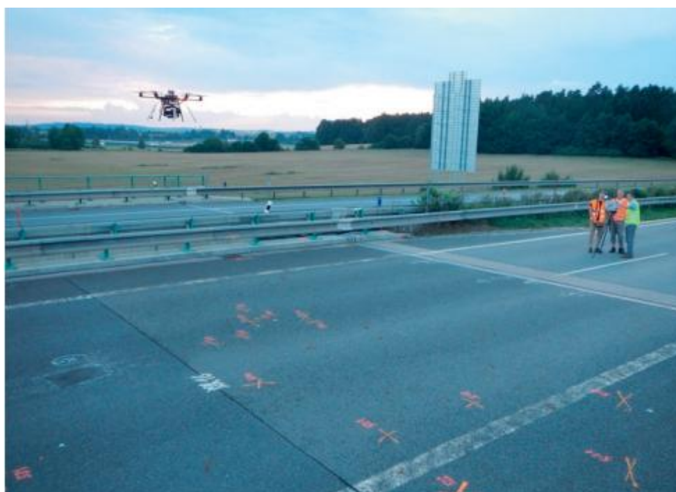
Figura 2.20– Inspeção térmica realizada a um troço da ponte Koberný e Ekanice, República Checa (Droneng, 2015).
