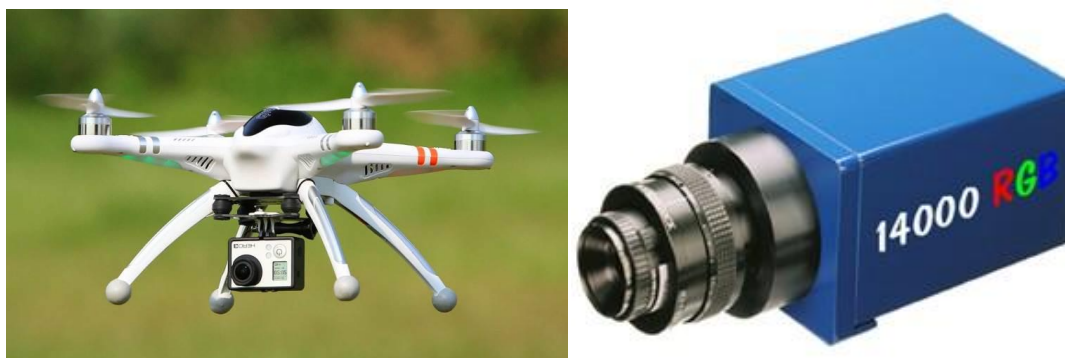
Figura 2.10– Câmara RGB incorporada num VANT (Texas e Digital, 2016).
