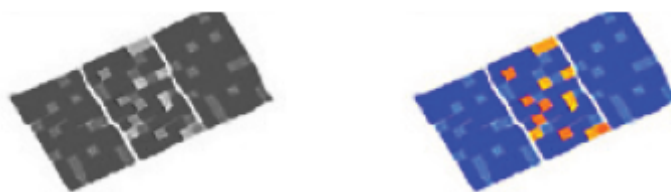
Figura 4.8– Anomalia em várias células do módulo, CM_SDBD_ISC_DC.
