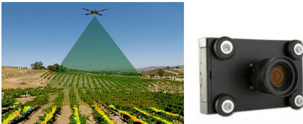
Figura 2.11– Câmara multiespectral incorporada num VANT no sector agrícola (Droneng e Digital, 2016).
