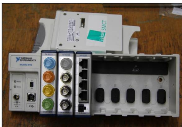
Figura 3. 3- Sistema de aquisição do equipamento de medições utilizado na análise modal.
