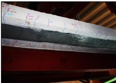
Figura 4. 28- Exemplo de aplicação de tecido de fibras de carbono ao longo de uma laje de BA suportada por vigas metálicas (Alwash & Jaber, 2014).
