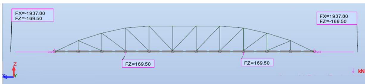
Figura 4. 11- Identificação das cargas equivalentes de pré-esforço no modelo numérico do tramo analisado.
