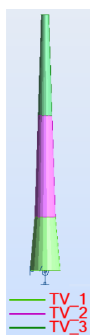
Figura 3.5- O segundo modelo estudado apresenta três segmentos anelares tronco cónicos.
