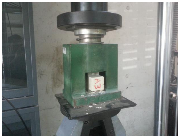
Figura 3.9 - Esquema do ensaio de compressão.
