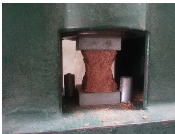
Figura 3.10 – Rotura do provete após ensaio à compressão.
