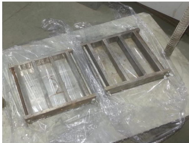
Figura 3.5 – Moldes utilizados para a construção dos provetes.
