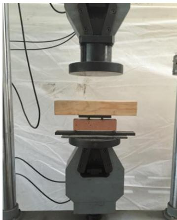
Figura 3.7- Esquema de ensaio à tração por flexão.
