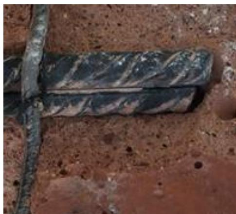
Figura 4.14- Escorregamento da armadura tracionada.
