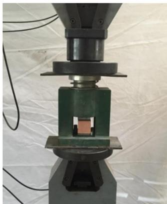
Figura 3.8- Esquema de ensaio de rotura à compressão.
