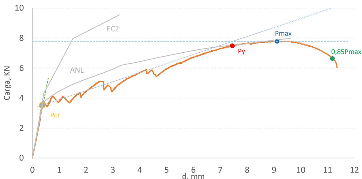
Figura 4.17- Curvas P-d experimental, teórica e ANL da Viga Vβ1.
