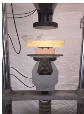
Figura 3.7- Ensaio de rotura à tração por flexão.
