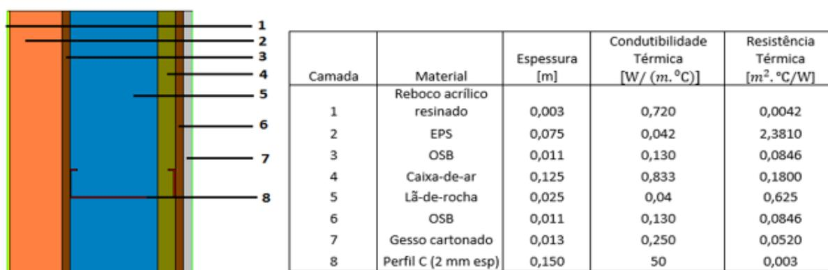
Figura 4.4 - Elemento parede com estrutura híbrida: 75 mm de EPS e 25 mm de lã de rocha.
