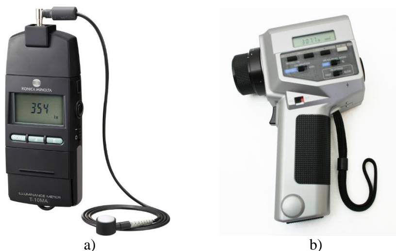
Figura 3.1 – Medidores de iluminâncias (a) e de luminâncias (b) (MinoltaIM@, 2016) (LuminanceM@, 2016).
