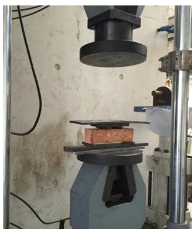
Figura 3.6 - Ensaio de rotura à tração por flexão.
