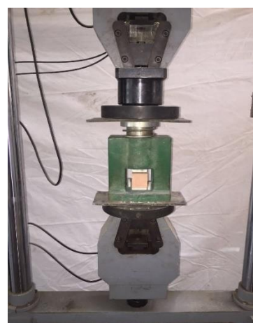
Figura 3.7 - Ensaio à rotura por compressão.
