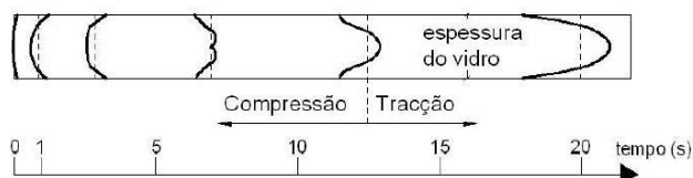
Figura 2.17. Campo de tensões ao longo do processo de têmpera (adaptado, Haldimann, 2008).
