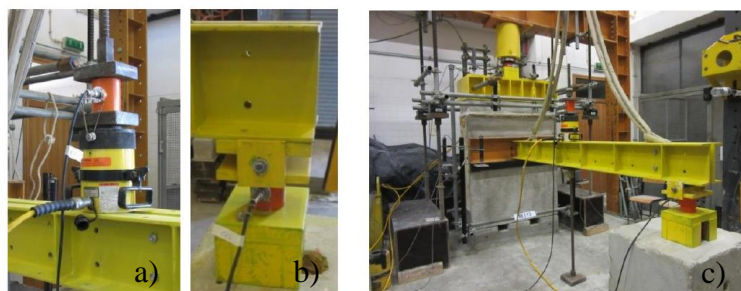
Figura 1.8 – a) Posicionamento do cilindro hidráulico e da célula de carga; b) Posicionamento da célula de carga e da rótula metálica; c) Aspeto geral de um dos ensaios (Simões, 2015)
