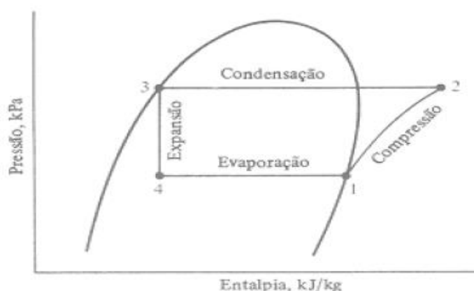
Figura 2.4 -Diagrama pressão-entalpia (P-h) do ciclo teórico de refrigeração (Fonte [8]).
