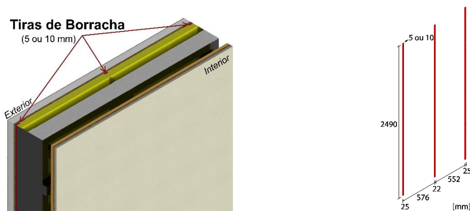
a) Localização das tiras de borracha na parede.
