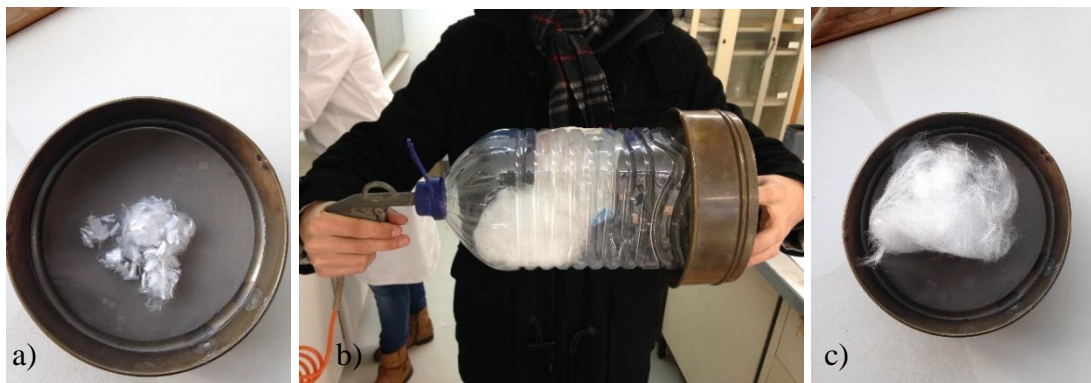
Figura 19 – Separação das fibras de polipropileno com ar comprimido: a) fibras de polipropileno agrupadas; b) sistema de separação das fibras com ar comprimido, garrafão e peneiro 200; c) fibras polipropileno separadas.
