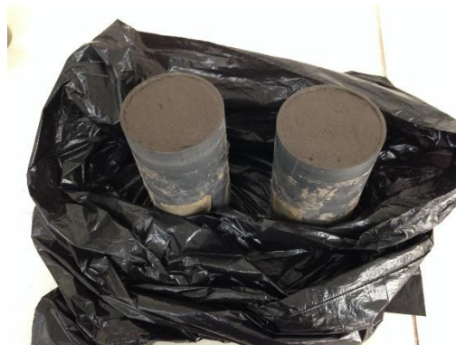
Figura 20 – Apresentação final do provete dentro do molde de PVC antes de ser fechado dentro de um saco de plástico e entrar na câmara termohigrométrica.
