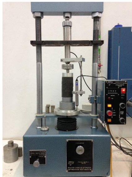
Figura 21 – Prensa Tristar 5000kg Stepless Compression Test Machine onde foram executados os ensaios de compressão simples monotônicos.
