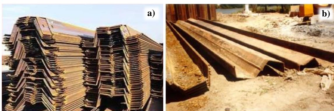
Figura 2.3: a) Tipo de estacas-pranchas; b) Pormenor do encaixe (Almeida e Sousa, 2007)
