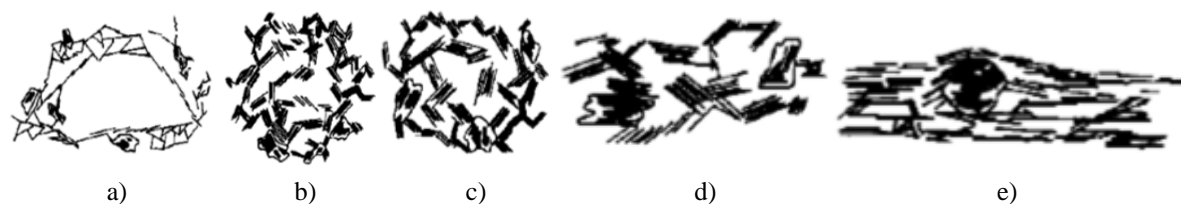
Figura 2.6 - Tipos de fábrica de argila para materiais ricos em esmectite/ilite. a) Partículas e cadeias, índice de vazios muito elevado > 3,0 ; b) domínios e cadeias de partículas, índice de vazios muito elevado > 2,5 ; c) índice de vazios médio a elevado \approx 1,5-2,5 ; d) baixo índice de vazios < 1,5 ; e) índice de vazios muito baixo < 1,2 (adaptado de Bennett et al. (1981))
