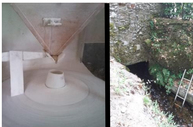
Figura 28: Moagem da farinha do Moinho de água de São Gião (esquerda) e passagem da água da levada que faz funcionar o moinho de água de São Gião (direita)
