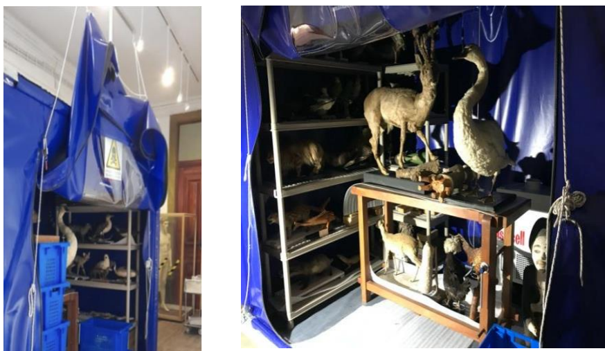
Figura 10- Câmara de Anoxia.
